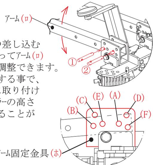
(14-1) アーム固定金具(ホ)の孔(A)-(B)を使用してアームを固定するとアームは下側5°で固定されうねを200~510mmの範囲で押さえる事ができます。
