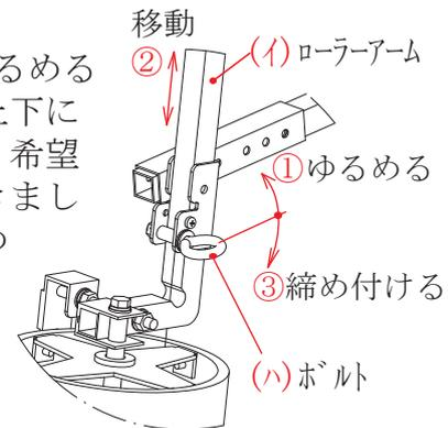
(13-2) ボルト(ハ)が回らない時はドライバー(ニ)のようなものをボルトに差し込んで回せば楽に回せます
