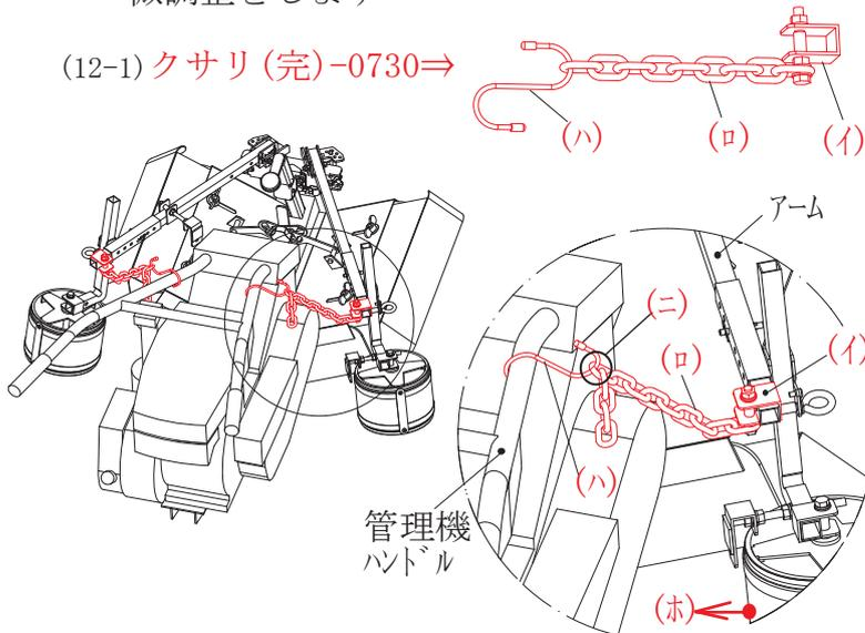
(12-2) クサリ(完)-0730のかげ部分(イ)をアームに取り付けます。反対側のS字フック(ハ)を管理機ハンドルに引っ掛けます。S字フックとカゲの引っ掛ける位置(ニ)の調整でローラーを内側(ホ)の方向へ引っ張り込む事が可能になります
